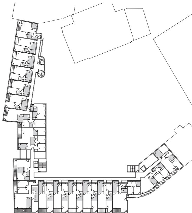
➤➤➤ La trame structurelle est une double garantie d'économie et de souplesse d'aménagement pour les logements. Du deux-pièces au six-pièces, le projet décline différents types d'appartements traversants desservis par coursives.
