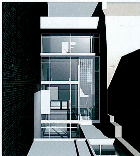
Image du projet pendant sa conception. À l'origine, la façade de l'escalier devait être entièrement réalisée en pavés de verre.
